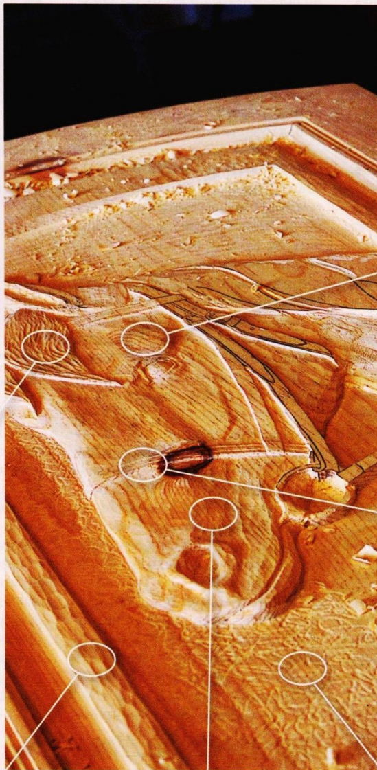
Отлогая стамеска шириной 25 мм для глубоких округлых выемок.
