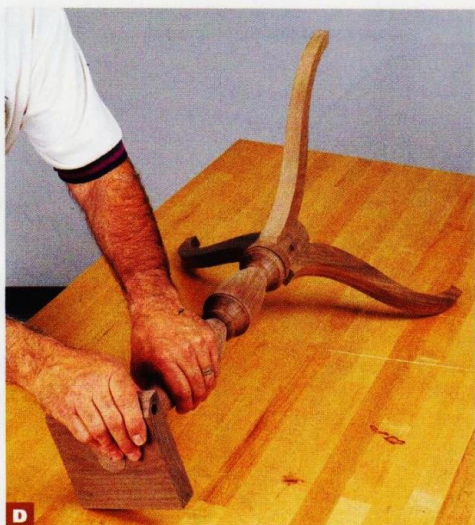
D Опирая основание на верстак двумя ножками, выровняйте осевой блок фаской вверх.
