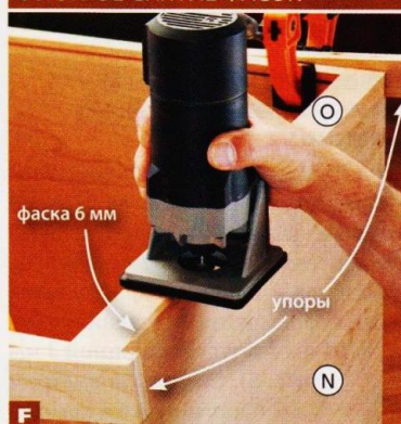
F Прикрепите к корпусу струбцинами упоры из обрезков, тогда фаски не будут доходить до концов детали примерно на половину размера подошвы кромочного фрезера (приблизительно 32 мм).
