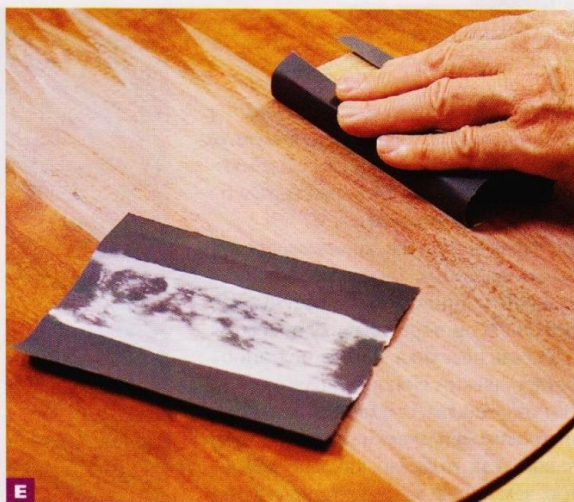
E При сухой шлифовке нитролака мелкозернистой бумагой верхний слой пленки превращается в белую пыль. Чаше меняйте бумагу, чтобы избежать ее засаливания. Закончив шлифовку, очистите поверхность тканью или сжатым воздухом.
