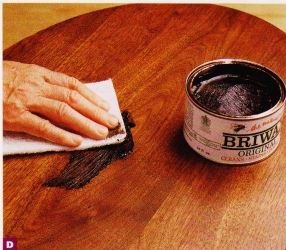
D Мелкие царапины на ореховом столе, отделанном масляно-лаковой политурой, можно отполировать неткаными абразивными подушечками, используя темно-коричневый воск Briwax.
