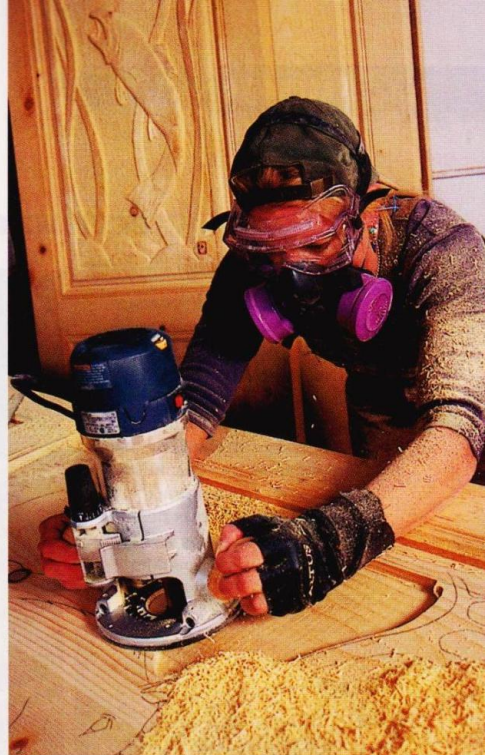
Для придания резьбе объемности Эмбер фрезерует фон вокруг центральных элементов на глубину 12 мм.
