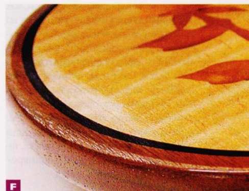
F Если пленка покрытия тонкая, ее легко протереть наждачной бумагой насквозь и обнажить древесину, как это случилось с оправой для зеркала.
