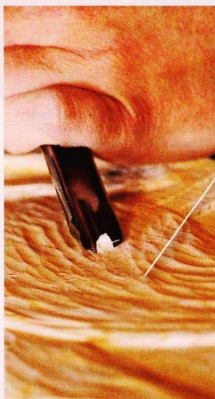
Полукруглый резец шириной 13 мм для неглубоких канавок.
