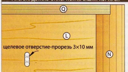
РИС. 5А. ДЕТАЛЬ ФАНЕРНОЙ КРЫШКИ КОРПУСА
